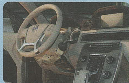
Freno e acceleratore manuali quasi invisibili
