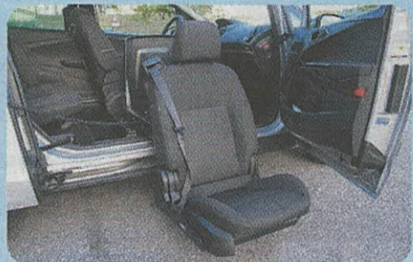
Sedile automatico che ruota e scende
